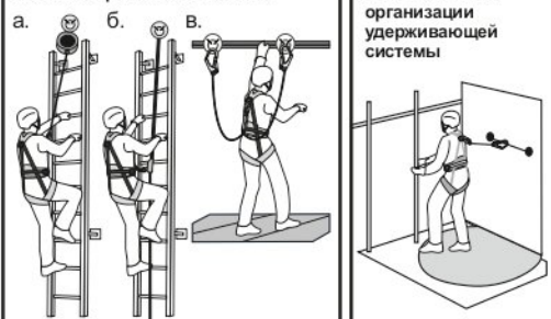
Рис. 13. Пример организации системы канатного доступа
