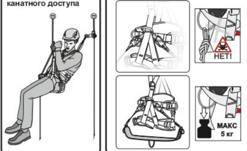
Рис. 13. Пример организации системы канатного доступа
